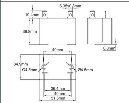
1 x 30A 250V ohmsch (AC1) (CE und UL) Schließer, versiegeltes Gehäuse, 6,35 x 0,8 Klemmen. Dieses Relais kann ohne Montageplatte direkt auf alle aus Kunststoff ausgelösten Fronten montiert werden, die für Kolben- und Kapillarthmostate und Elektronische Regler vorgesehen sind, sowie auf die flachen Fronten der Verteilerkästen in diesem Katalog. Spule 200-240V AC.
