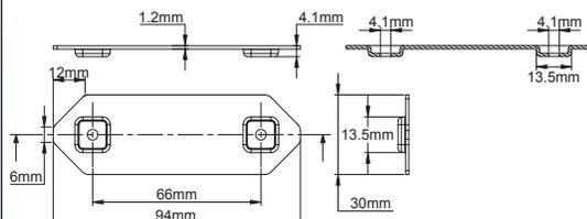
Für Nebeneinandermontage eines Kastens mit wettergeschütztem Lüfter auf einem anderen Kasten mit den gleichen Abmessungen.
