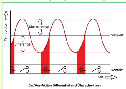
**Einstellbares Differential:** Ein niedriges Differential wird oft mit der Regelgenauigkeit in Verbindung gebracht. Ein zu niedriges Differential führt jedoch zu kurzen Heizzyklen und vorzeitigem Kontaktverschleiß, wenn ein Leistungsrelais verwendet wird, oder zu einem schnellen Abbau des Verdichters, wenn das System zur Steuerung eines Kühlschranks verwendet wird. Die elektronischen Regler in diesem Katalog verfügen über ein einstellbares Differential, um diesen Betrieb zu optimieren.
