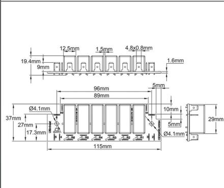
Elektronische Relais-Platine, 6 Relais 16A 250V. Sie sind in 4 bis 6 Relais erhältlich, Schließer. Die Relais-Spulen werden einzeln gespeist, 220-240V. 4,8 x 0,8 Klemmen. Sie können direkt auf allen erweiterten Thermostat-Montageplatten aus Kunststoff, auf den Platten der elektronischen Regler und auf den flachen Kunststoff-Verteilerkästen installiert werden. Mit Steckbrücken können Relais-Spulen für den gleichzeitigen Betrieb zusammengeschaltet werden.
