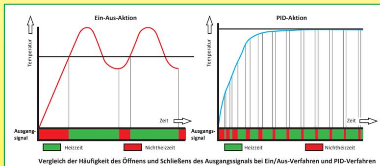
Die PID-Regelung kann zwar die Regelung in einer Reihe von Konfigurationen verbessern, hat aber den Nachteil, dass das Ausgangssignal sehr schnell zyklisch wird, was die Lebensdauer der Leistungsrelais stark verkürzt und in den meisten Fällen den Einsatz von Halbleiterrelais erfordert.
