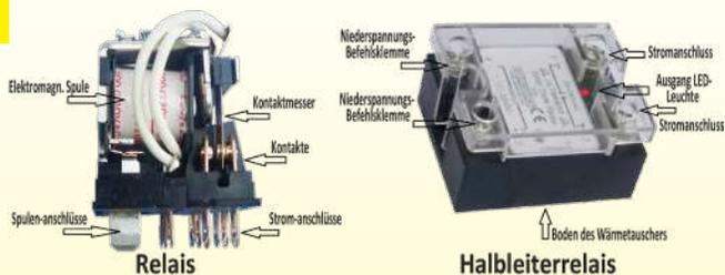
**Das Relais oder elektromechanische Schütz:** Die Spule besteht aus einer sehr großen Anzahl von Windungen eines sehr dünnen Kupferdrahtes. Wenn ein ausreichender Strom durch die Spule fließt, erzeugt sie ein Magnetfeld, das den beweglichen Teil anzieht und die Zungen mit den elektrischen Kontakten bewegt. Fließt der Strom in der Spule nicht mehr, kehren die Kontakte dank einer Rückstellfeder in ihre Ausgangslage zurück.
