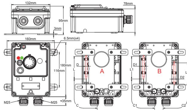
A: 1-Kolben-Modell, nur Temperaturregelung.
