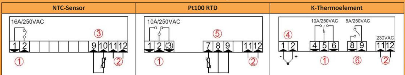
1: Relais-Ausgang; 2: 230V AC-Stromversorgung; 3: NTC-Sensor; 4: K-Thermoelement-Sensor; 5: Pt100-Sensor; 6: Alarm-Relaisausgang.
