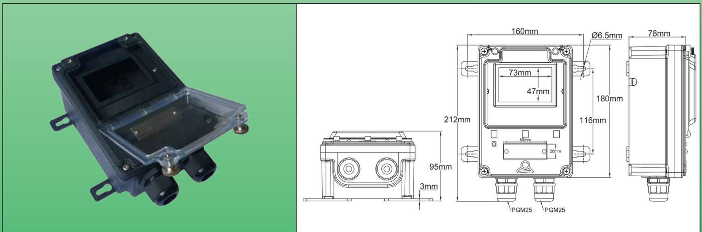
Ermöglicht die Montage eines Leistungsschalters des Typs Merlin Gerin Multi 9 (UL, CSA, IEC) und der entsprechenden europäischen Baureihen Vigi C60 oder C60 (72mm max. Breite = vier 18mm Module), oder der in diesem Katalog beschriebenen Elektronischen Regler.
