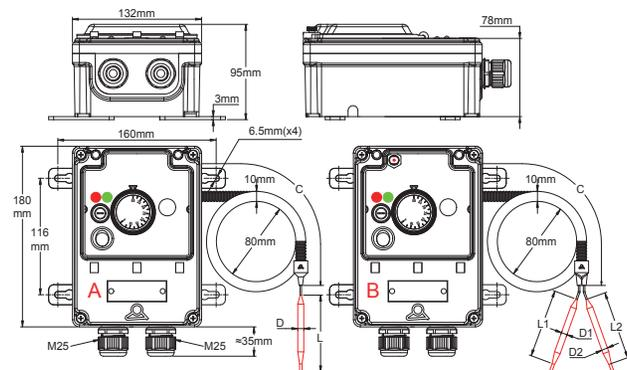
A: 1-Kolben-Modell, nur Temperaturregelung.
