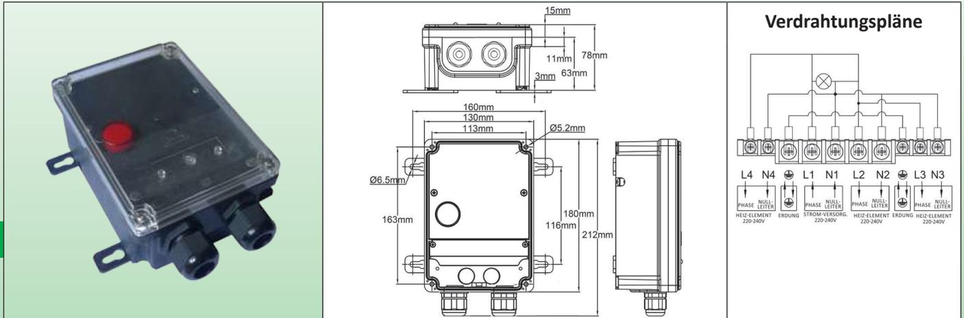
**Verdrahtung:** Stromversorgung Nullleiter + Phase + Erdung an einem 6mm<sup>2</sup> Klemmenblock, und Abgänge an 3 Heizkabgängen 1,5 oder 2,5mm<sup>2</sup>.
