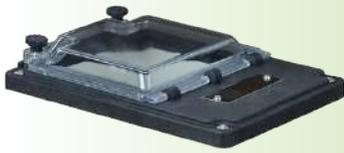
Der Standard für Temperaturregler aus PA66 mit transparentem Polycarbonat-Fenster für Anwendungen, die einen häufige(n) Zugang oder Einstellung erfordern, ohne elektrische Gefahr: Kein Zugang zum Anschlussblock bei offenem Fenster.
