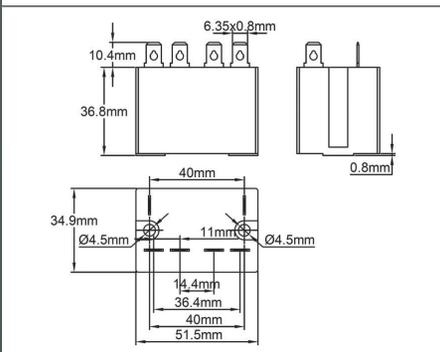
2 x 25A 250V ohmsch (AC1) (CE und UL) Schließer, versiegeltes Gehäuse, 6,35 x 0,8 Klemmen. Dieses Relais kann ohne Montageplatte direkt auf alle aus Kunststoff ausgelösten Fronten montiert werden, die für Kolben- und Kapillarthmostate und Elektronische Regler vorgesehen sind, sowie auf die flachen Fronten der Verteilerkästen in diesem Katalog. Spule 200-240V AC.
